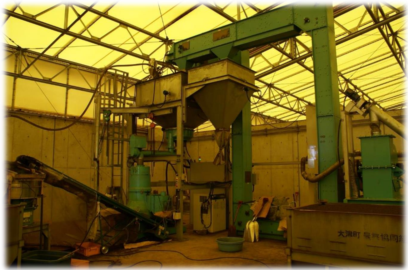
自動ペレット製造装置
