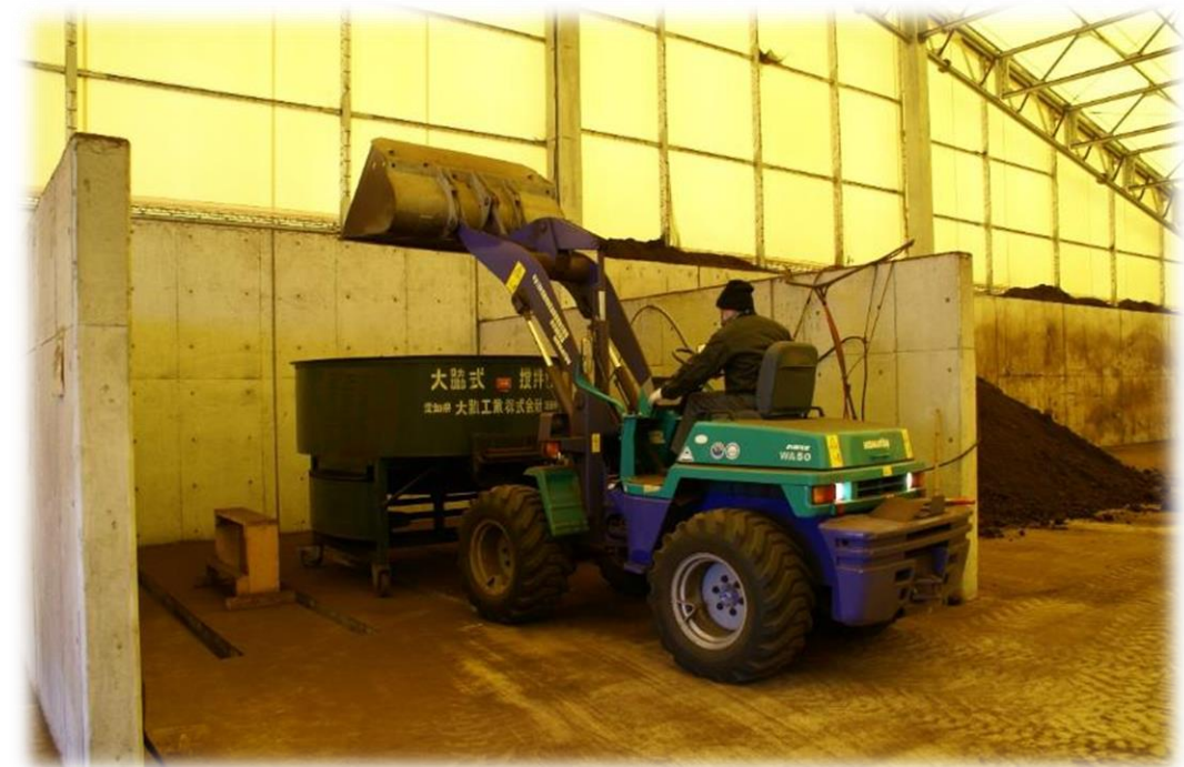
混合機への原料投入
