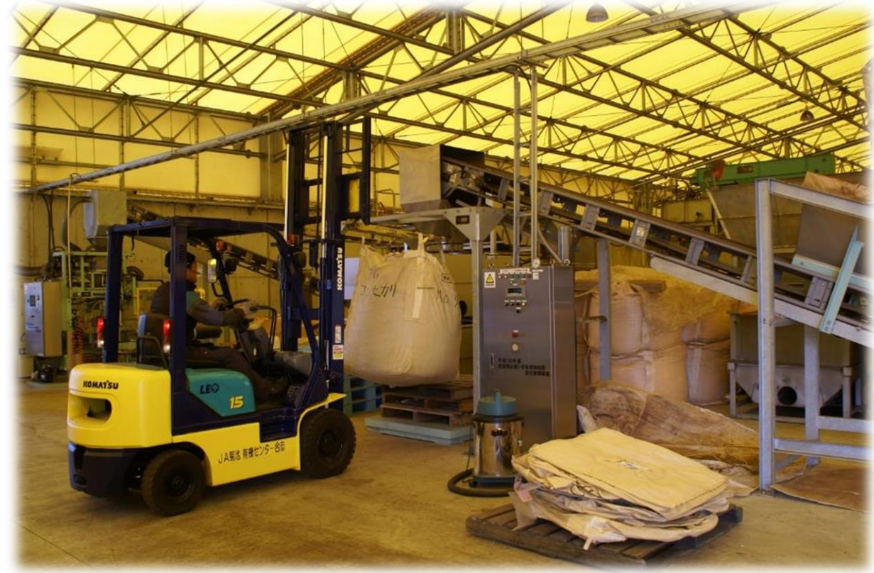
フレコンバックへの詰め込み
