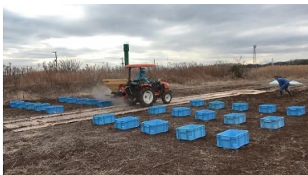
堆肥入りBB肥料の散布試験 (堆肥の粒径や形の影響)
